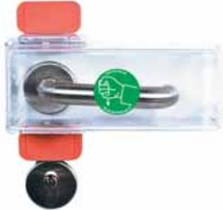
Die Haube „K“ besteht aus unzerbrechlichem Macrolon-Kunststoff, so dass sie wieder verwendet werden kann. Im Gefahrenfall einfach Haube abschlagen. Zum erneuten Sichern des Türgriffs benötigt man neue rote Befestigungsplatten Nr. 901292 (= 6 St.). Die Fluchttürhaube gibt es auch zur Absicherung von Treibriegel „Typ E“ bei Fenstern oder Türen mit normalem Rahmen Nr. 901290.
